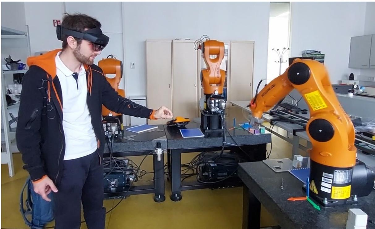
Der derzeitige Softwarestand demonstriert die erfolgreiche Ansteuerung eines KUKA Industrieroboters mithilfe der Gestenerkennung der HoloLens 2. Es wurden die wichtigsten Komfortfunktionen realisiert, sodass der Roboter angelern werden kann. Im Kapitel *Bedienung* gehen wir näher auf alle Funktionen ein. Im Kapitel *Dokumentation* gehen wir außerdem auf die verwendete Hardware, die Protokolle und internen Berechnungen ein, die nötig waren, um den KUKA zum Leben zu erwecken.
